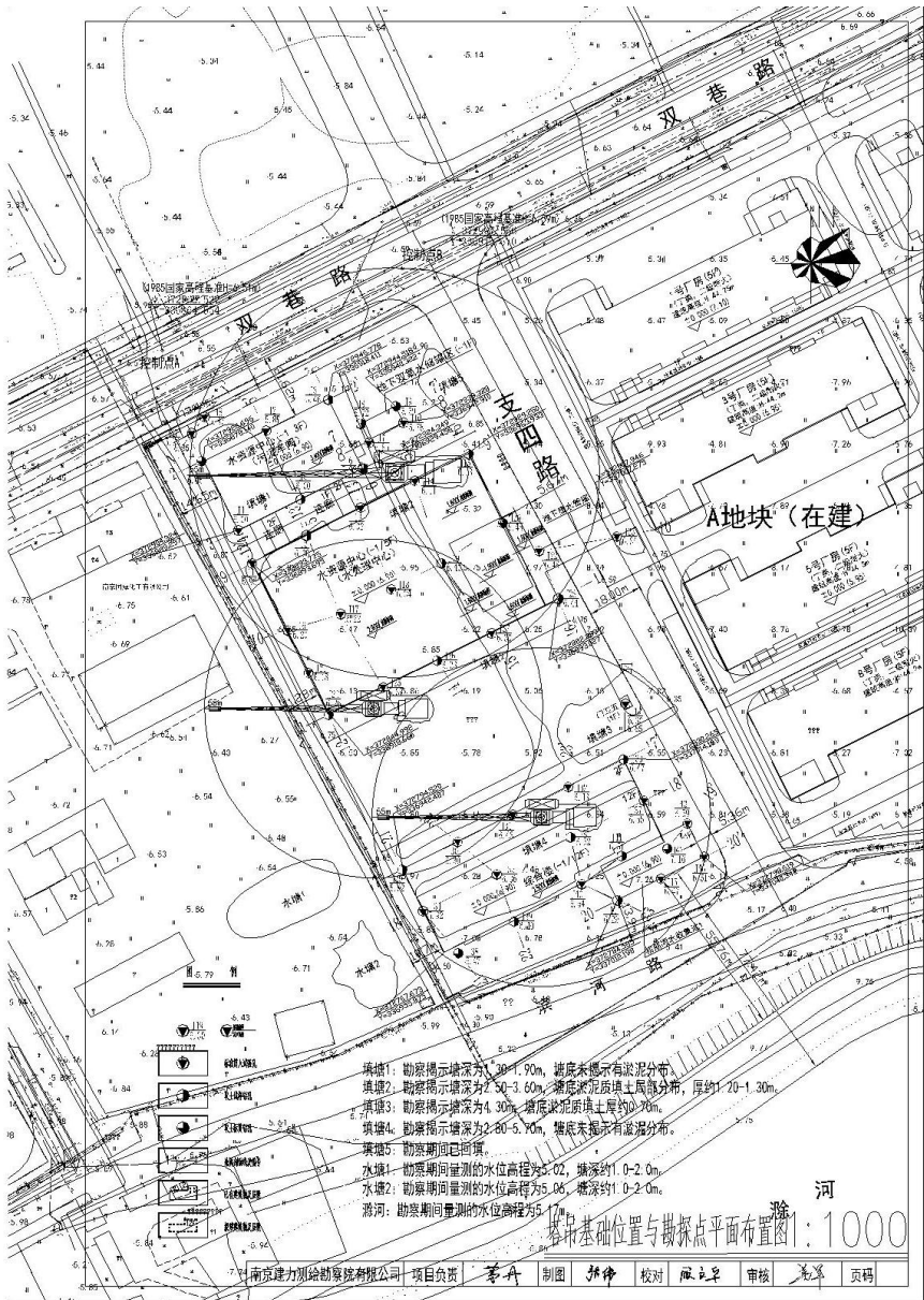
塔吊基础位置与勘探点平面位置图
