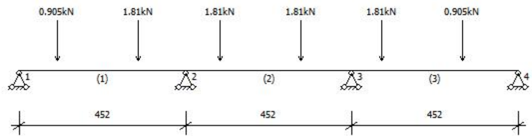
长边柱箍计算简图
