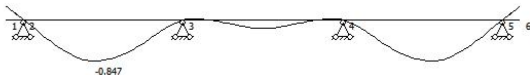
主梁变形图二(mm)
