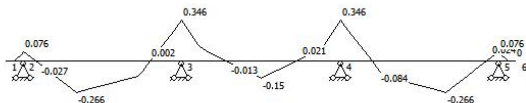
主梁弯矩图二(kN·m)
