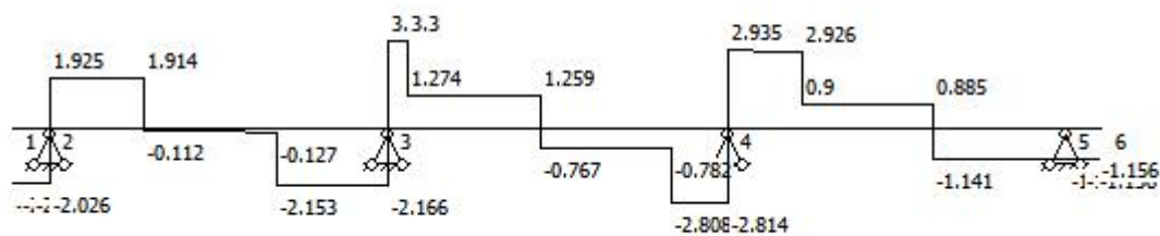
主梁剪力图一(kN)
