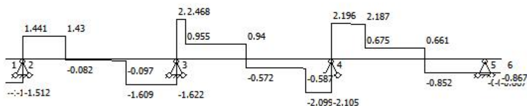
主梁剪力图一(kN)
