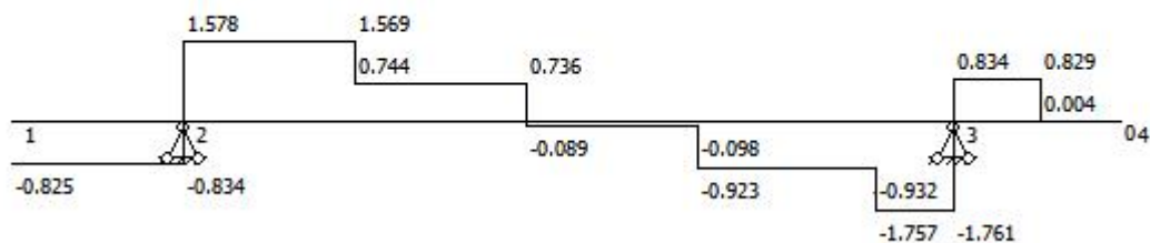
主梁剪力图一(kN)
