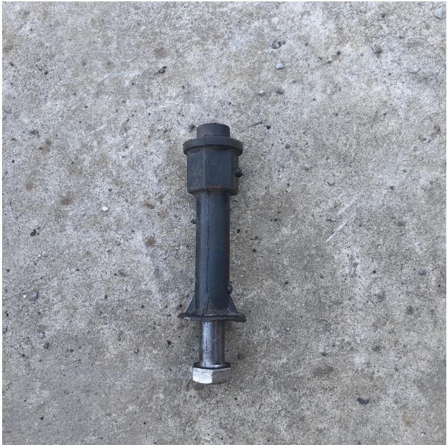
脚手架刚性连墙件构造示意图
