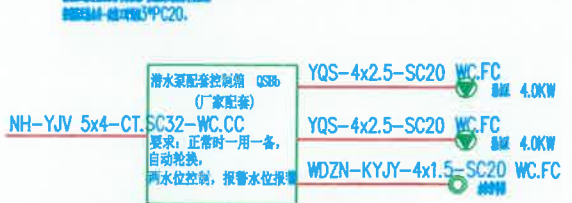
消防电梯集水井潜水泵控制箱系统图
