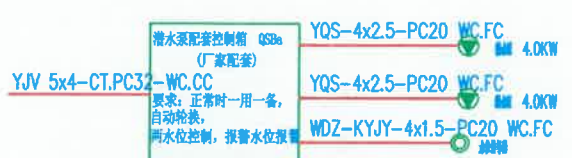
货梯集水井潜水泵控制箱系统图
